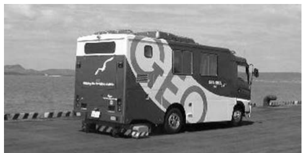
図-1 7 個のアンテナを装備した路面下空洞探査車
