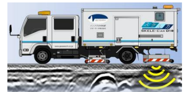
図-1 空洞探査車と取得データ例
