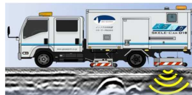
図-1 空洞探査車と取得データ例
