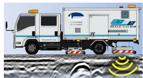
図-3 空洞探査車と取得データ例
