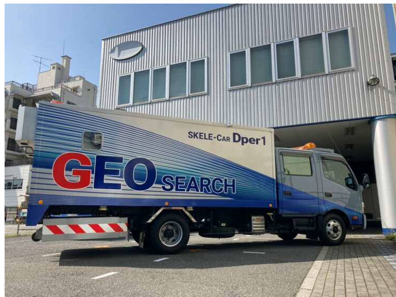
2022年5月 スケルカ Dper（地下3mまで可視化可能な空洞探査車）始動
