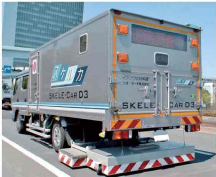
探査車「スケルカ」は時速60km/hで走行しながら空洞探査が可能
