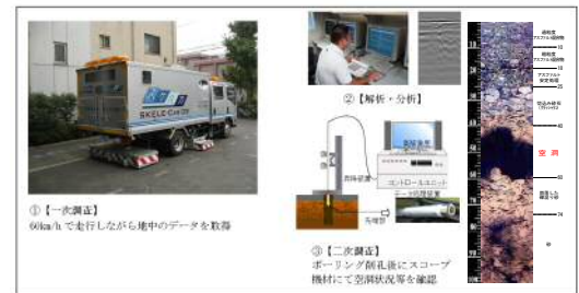
図-1 空洞探査手順
